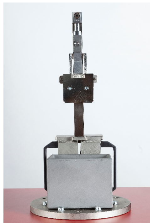
15kN 荷重センサ内蔵型台座、接着された試験片、ウェッジ
