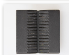
V溝付きヤスリ目 太い金属ワイヤ、チューブなどの直径の大きな丸い試験片や、硬いプラスチック材料などに
