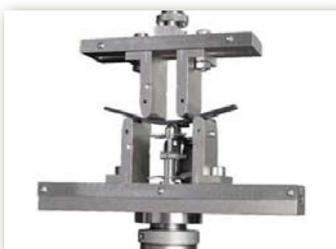
中点たわみ計を用いた4点曲げ治具
