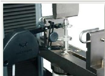
ひずみゲージ式伸び計によるたわみ計
