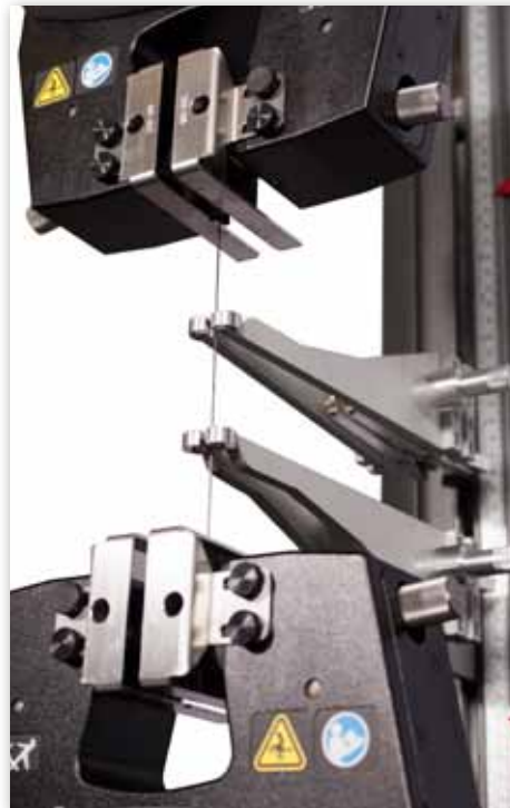
AutoXを用いた空気圧式サイドアクショングリップ内の炭素繊維の短線
