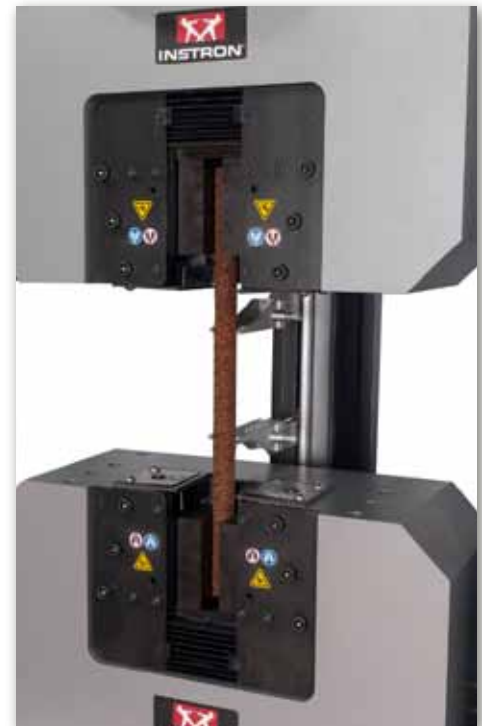
1500KPX油圧式フレームにおけるAutoXを用いた鉄筋バーの試験
