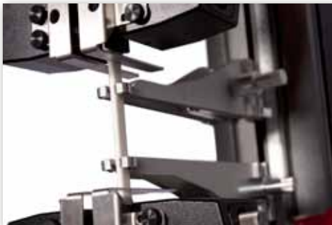
電気機械式フレームにおけるAutoXを用いたプラスチックの引張試験
