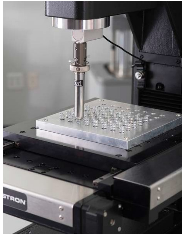
外科用器具に使用されるバネの圧縮試験
