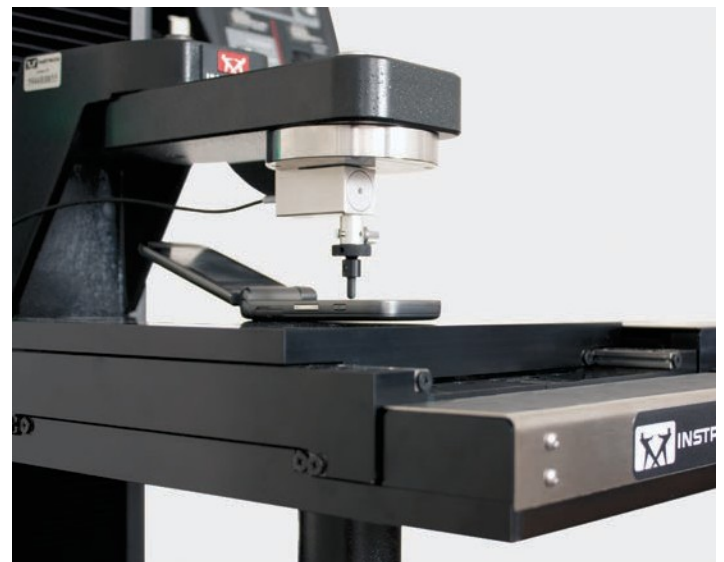
複数の携帯電話ボタンでのフィーリング試験
