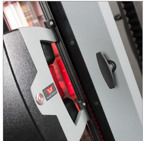
AVE2が恒温槽に取り付けられた状態
