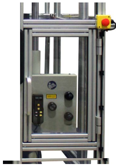
試験中に試験エリアへの立ち入りを制限するインタロック付き安全ガード
