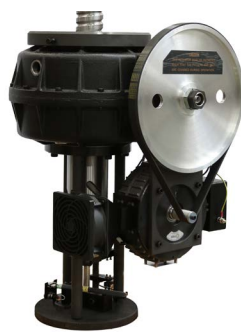
低ひずみ速度試験用に特別に設計されたバックラッシュの無い電気サーボ式アクチュエータ(オプション)
