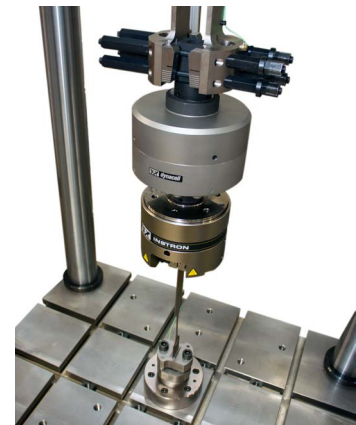
穿孔プローブと計装ヘッド
