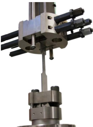
衝撃の反発を軽減するための特許を取得した Fast Jaw 引張グリッピング
