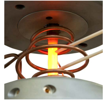
コレットグリップは環状試験片の内部冷却をサポートする機能を標準装備
