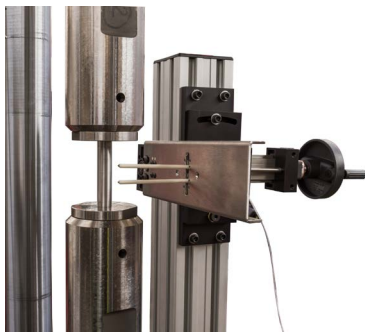
低い接触力の高温伸び計強制冷却機能付きの取付位置の高い再現性を有する取付ブラケット
