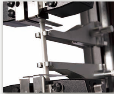
電気機械式フレームにおいてAutoX750を用いた塑性引張試験
