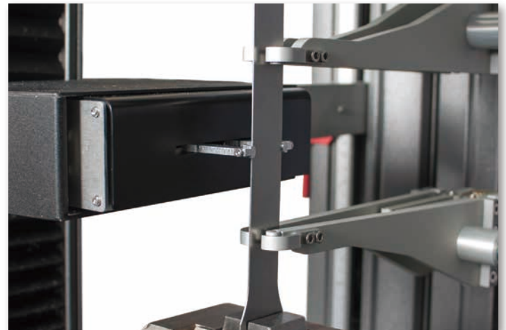
標点距離の中心を自動的に測定
