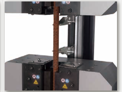
1500KPX油圧式フレームにおいてAutoX750を用いた鉄筋棒鋼試験
