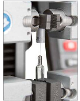
G.6 チップキャップまたは、 針シールドの引き抜き力 試験
