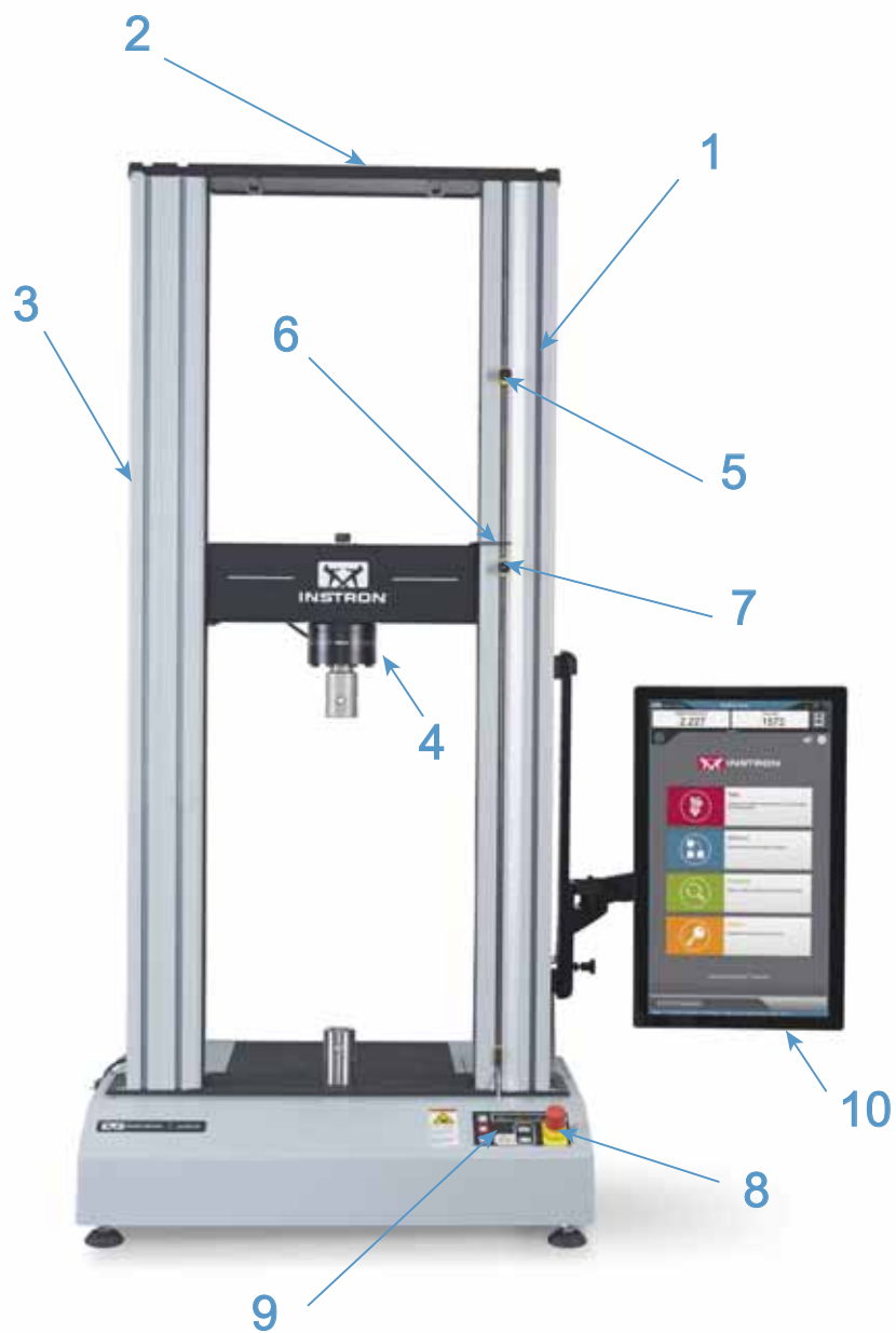
図 1. Bluehill® オペレータ ダッシュボード 付きの 3400 デュアル コラム 卓上モデル - 正面図
