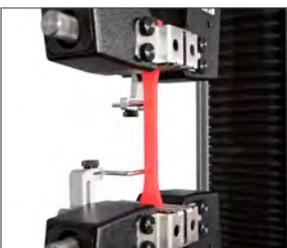
試験片センタリングデバイスを使用することで試験片の位置決めを正確に行うことができます。
