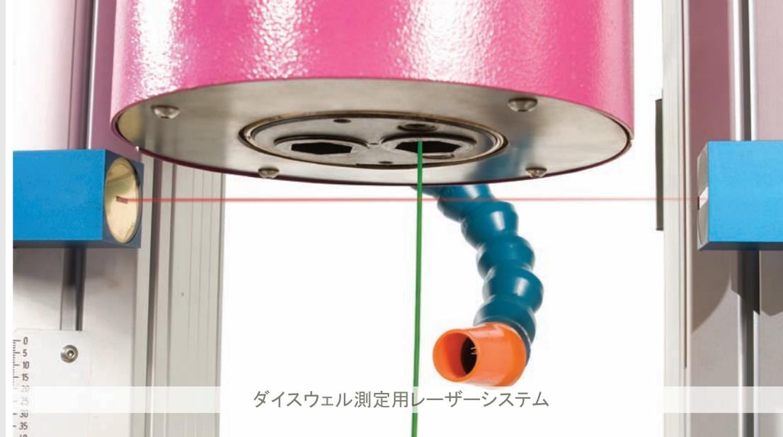
ダイスウェル測定用レーザーシステム
