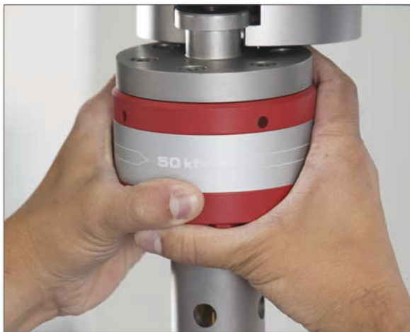
クイックマウントキットを備えた50 kNロードセル
